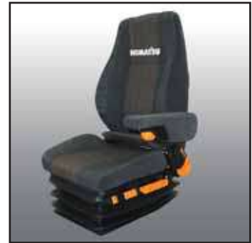
Asiento con suspensión neumática
