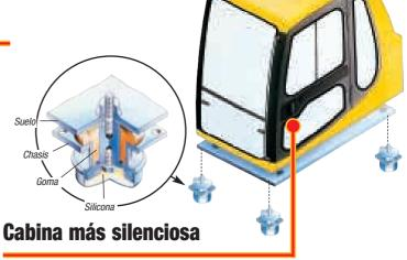
El nuevo sistema de amortiguación de la cabina reduce las vibraciones y el ruido, asegurando un entorno laboral más silencioso, lo cual reduce la fatiga del operador mejorando asimismo su concentración.
